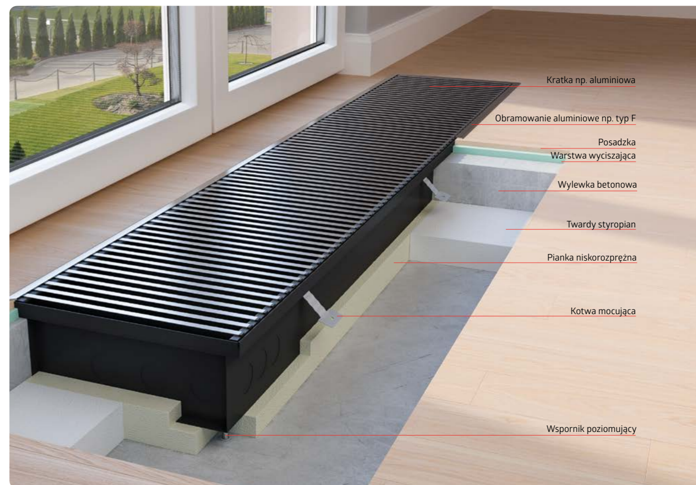
Przykładowy montaż płytkiego grzejnika kanałowego
