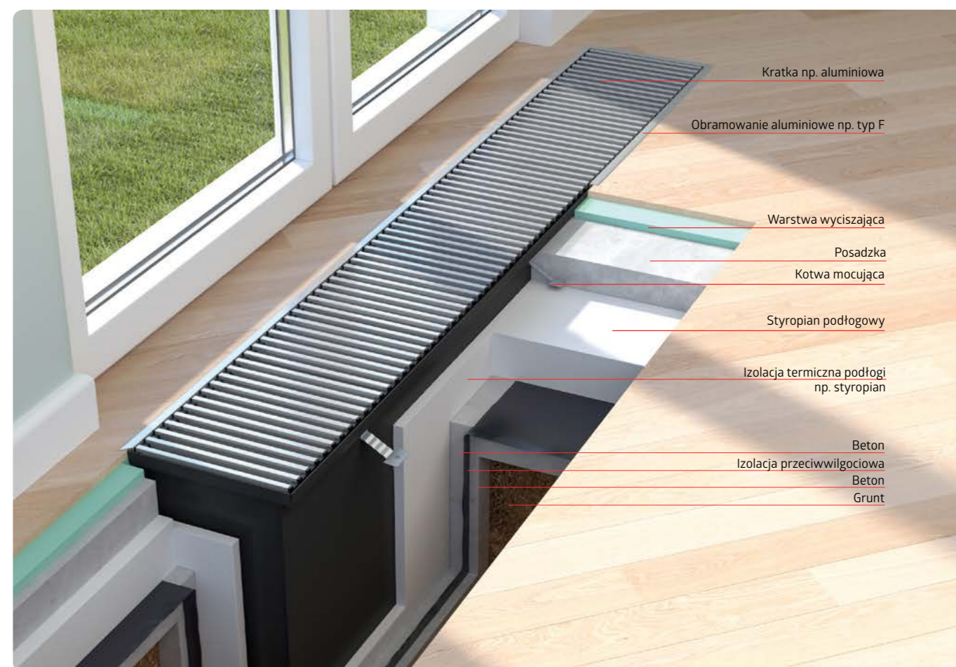
Przykładowy montaż głębokiego grzejnika kanałowego
